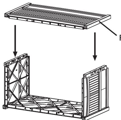
6. サイドパネルの溝をしっかりと確認して押しではめ込みます。
